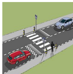
9. ÖVERGÅNGSSTÄLLE MED GUPP
