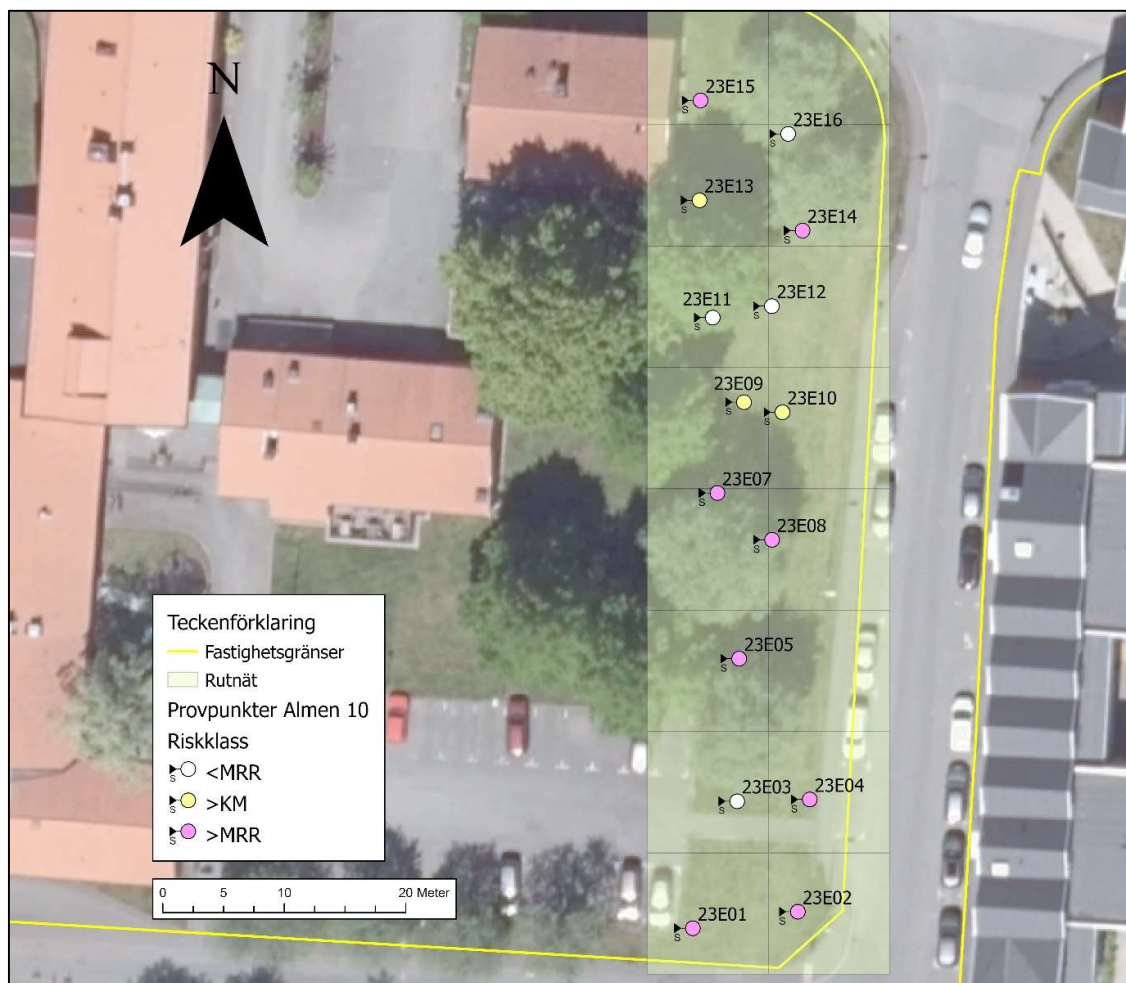
Figur 6. Översiktskarta med inmätta punkter för jordprovtagning med grävmaskin inkl. riskklassning enligt Naturvårdsverkets riktvärden för förorenad mark. Förstorad karta återfinns även i Bilaga 1. © Ensucan AB
