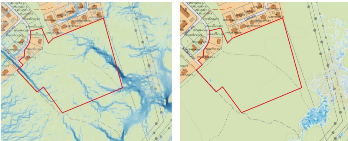
Figur 9: Kartbilder från kommunens skyffallskartering. Till vänster visas maximalt flöde och höger maxdjup efter 8 timmar.
